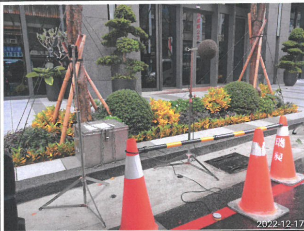
六合路(基地旁) (噪音振動採樣情形)
