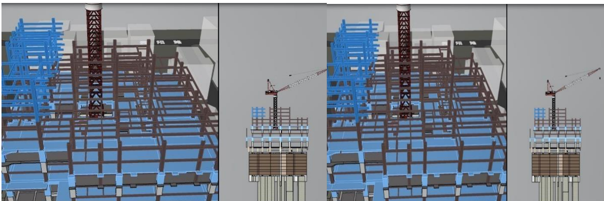
運用 BIM 模擬雙順打及逆打工法對應時程之施工情形
